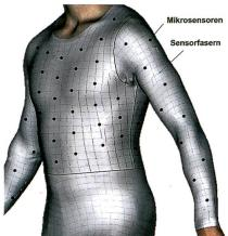
Abb. 2: Konzept für die Erkennung von Körperbaltungen mit Mikrosensoren und Sensorfasern in der Bekleidung
