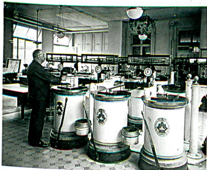
Abb. 1: Mit diesen Trocknungsöfen wurde um 1918 die Seide getrocknet
