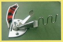
Einfasser mit Bandbremse
