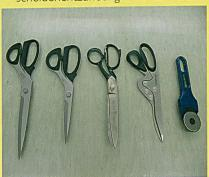
Für den Zuschnitt von Futter haben sich auch die Rollmesser bewährt, bei welchen man mit Druck und einer entsprechenden Unterlage das Futtermaterial zuschneiden kann.
