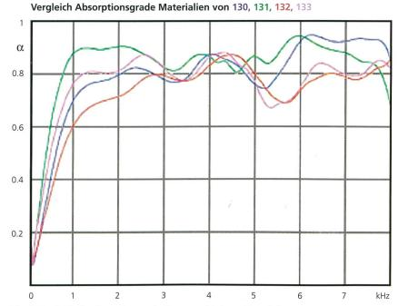
Abb. 4: Vergleich des Absorptionsverhaltens verschiedener Materialien
