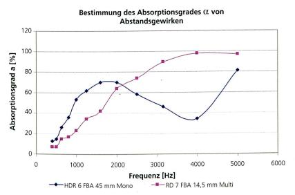
Abb. 3: Bestimmung des Schallabsorptionsgrades verschiedener Abstandsgewirke
