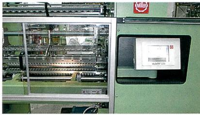
Abb. 2: Die kompakte Raschelmaschine MDK80 mit bedienungsfreundlichem Touchscreen
