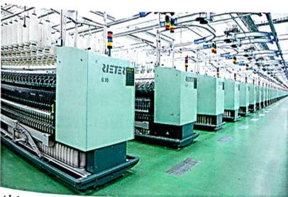
Abb. 1: Ringspinnmaschine G 35
