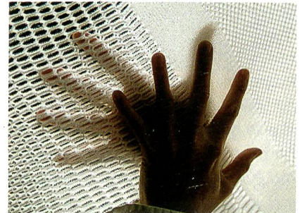
Abb.1: Abstandsgewirke in Trennwänden bieten Separation ohne Käfig-Effekte
