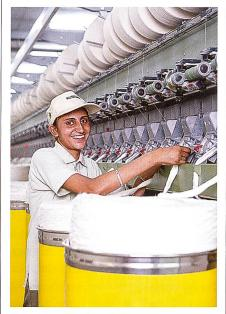
Rotorspinnmaschine R 40
