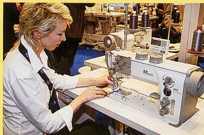
Industrienähmaschinen Reihe M-Type: Doppelstich-Flachbrettmaschine – DÜRKOPP-ADLER, Foto: Kölnmesse
