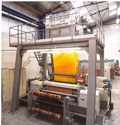
Abb. 3: Die Samtwebmaschine Velvet Tronic VTR33
