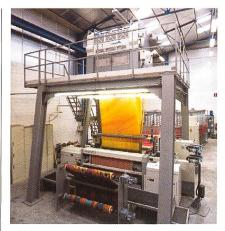
Abb. 3: Die Samtwebmaschine Velvet Tronic VTR33
