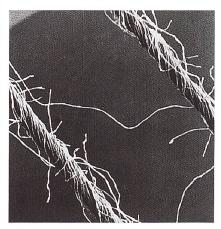
Abb. 2: Struktur des Rotorgarnes
