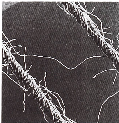
Abb. 2: Struktur des Rotorgarnes
