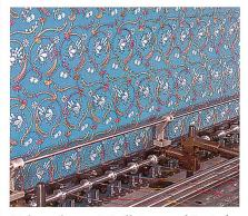
Stickmaschine mit Pailletten- und Soutacheeinrichtungen
