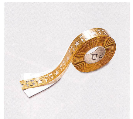
Abb. 5: Beispiel für eine Wicklung: Papierstreifen unter und Cellophanschut über der letzten Bandlänge
