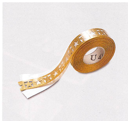
Abb. 5: Beispiel für eine Wicklung: Papierstreifen unter und Cellophanschut über der letzten Bandlänge
