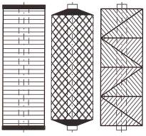
Abb. 3: Wickelbilder für die Aufmachung auf Spulen: Parallel-, Vielkreuz- und Präzisionskreuzwicklung (v.l.n.r.)
