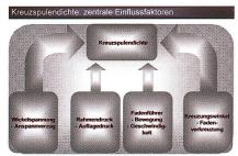
Abb. 11: Einflussfaktoren auf die Kreuzspulendichte
