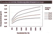
Abb. 12: Wickelspannung und ihr Einfluss auf die Kreuzspulendichte
