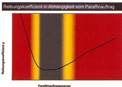
Abb. 8: Garnreibwert in Abhängigkeit von der Paraffinauftragsmenge
