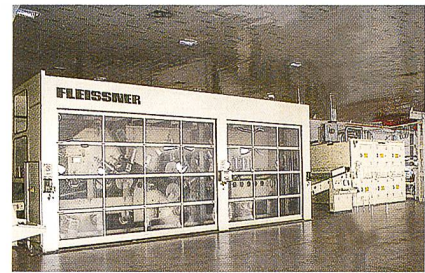
Abb. 4: PES/Pulp-Anlage mit zwei Krepeln mit Faseröffnung, einer Airlaid-Einheit, einer Wasservernadelung, einem Trockner sowie einem Wickler
