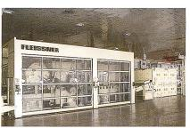
Abb. 4: PES/Pulp-Anlage mit zwei Krempeln mit Faseröffnung, einer Airlaid-Einbeit, einer Wasservernadelung, einem Trockner sowie einem Wickler
