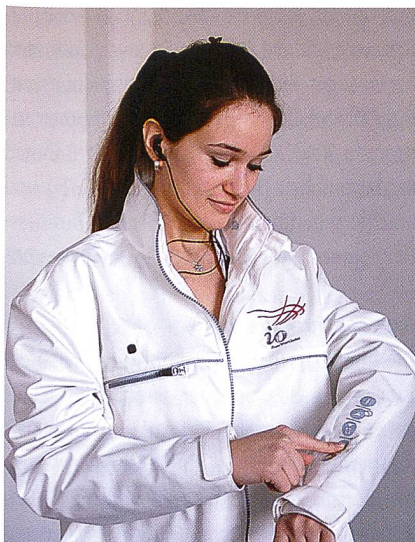
GPS/Galileo-Demo-Jacke mit stossfester Tastatur
