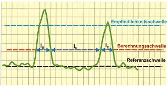
Abb. 1:  $l_r = L\ddot{a}nge$  des Effektes,  $l_s = Distanz$  zwischen den Effekten
