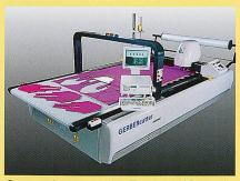
Cutter – Automatischer Zuschnitt (Gerber )
