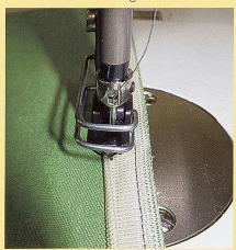
Spezial-Nähfuss mit aufgestellter RV-Spirale
