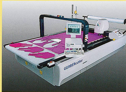
Cutter – Automatischer Zuschnitt (Gerber)
