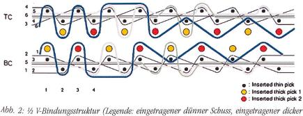
Abb. 2: ½ V-Bindungsstruktur (Legende: eingetragener dünner Schuss, eingetragener dicker Schuss 1, eingetragener dicker Schuss 2, TC — Oberteppich, BC — Unterteppich)
