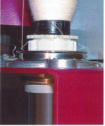
Abb. 3: Unterwindefreies Doffen mit SERVOgrip reduziert Faserflug und Fadenbrüche
