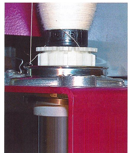
Abb. 3: Unterwindfreies Doffen mit SERVogrip reduziert Faserflug und Fadenbrüche
