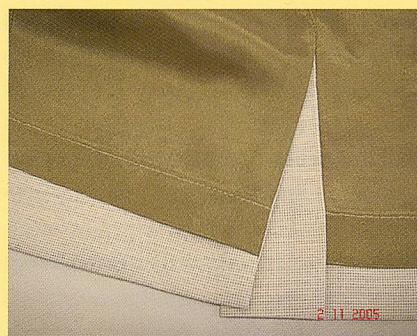
Übertritt Saum-Ecke Variante 2 mit verstärkter Naht
