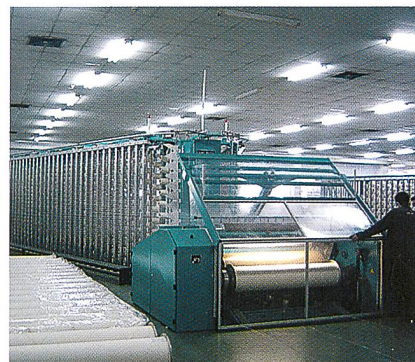
Abb. 3. Färbebaumzettelmaschine mit der neuen Wickeldichtenregelung
