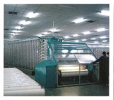
Abb. 3. Färbebaumzettelmaschine mit der neuen Wickeldichtenregelung
