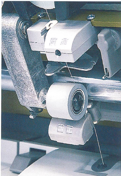
Der neue optische Garnreiniger IQplus®
