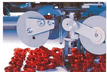
Mit einer Geschwindigkeit von bis zu 850 Stiche/min. können ZSK Spezialstickmaschinen, wie hier im Bändchenbetrieb, Effektmaterialien wie Bändchen, Kordeln und Ketten zu ganz neuen, eindrucksvollen Stickbildern verarbeiten.
