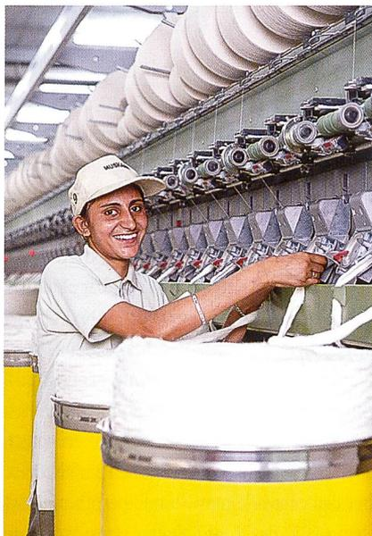
Rotorspinnmaschine R 40
