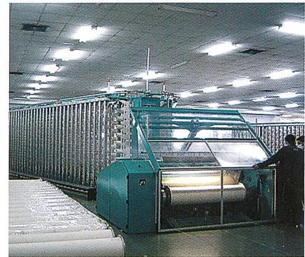
Abb. 3. Färbebaumzettelmaschine mit der neuen Wickeldichtenregelung
