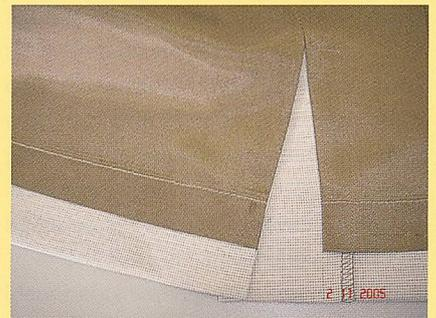
Übertritt Saum-Ecke Variante 1 mit sichtbarer Overlocknaht
