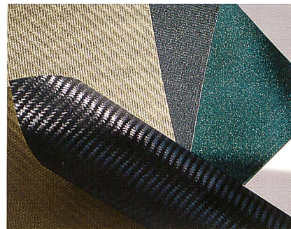
Abb. 1: ContiMetalflex®, ein elastomerer Verbundstoff, beschichtet mit Metall- oder Effektpigmenten und einer schmutzabweisenden Oberfläche, kann in vielen Bereichen eingesetzt werden
