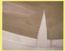
Übertritt Saum-Ecke Variante I mit sichtbarer Overlocknaht
