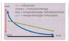
Abb.4: Entwicklung der Selbstkosten einer Färbung auf dem Foulard
