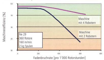
Abb 4: Höheres Produktivitätspotential mit höheren Ansetzerzahlen und 4 Robotern
