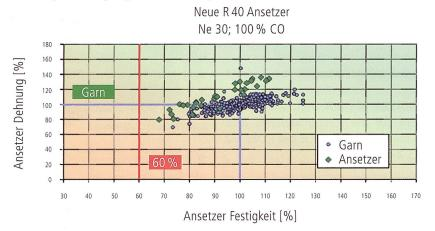
Abb 3: Sicherheit bei der Weiterverarbeitung: Die Qualität der Ansetzer ist mit dem Garn vergleichbar
