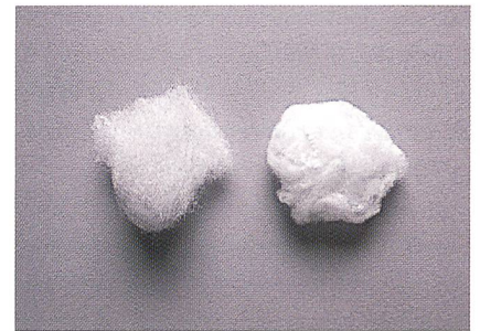
PPS-Stapelfasern 2,2 dtex, / 60 mm (rechts) und 7,7 dtex / 80 mm (links)
