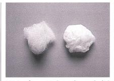
PPS-Stapefasern 2,2 dtex, / 60 mm (rechts) und 7,7 dtex / 80 mm (links)
