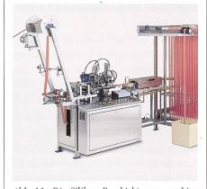
Abb 11: Die Silikon-Beschichtungsmaschine SB 22-S 2K
