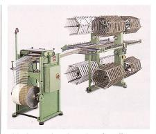
Abb. 6: Die Schneidmaschine für Effektgarne
