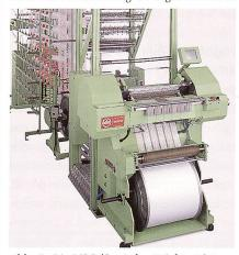
Abb. 7: Die MDR42 wird mit 8 bis 24 Legebarren geliefert
