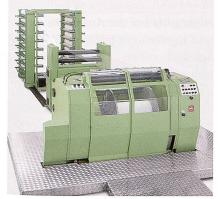
Abb. 3: Die Zettelmaschine MW1000U für elastische und nichtelastische Garne
