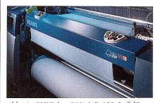
Abb. 1: OMNIplus 800 4 P 190 Luftdüsenwebmaschine
