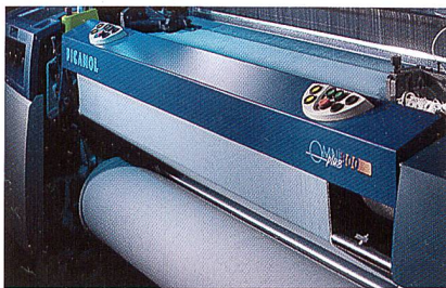
Abb. 1: OMNIplus 800 4 P 190 Luftdüsenwebmaschine
