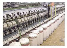
Abb. 5: Die Rotorspinnmaschine BT 904 für elastische Rotona<sup>®</sup>-Garne
