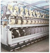
Abb. 1: Die Direktkabliermaschine CD 10
