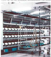
Abb. 2: Falschdrahttexturiermaschine GOAL 1210 FINE
