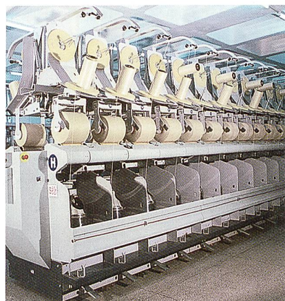
Abb. 1: Die Direktkablermaschine CD 10
