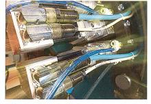
Abb. 1: Inlineantrieb für die Grundlegebarren der neuen Spitzenmaschinengeneration
