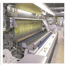
Abb. 2: Teppichwebmaschine bei Lantal Textiles
