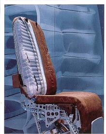
Abb. 1: Pneumatischer Flugzeugsitz
