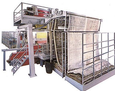
Abb. 7: Die Doppel-Teppichwebmaschine ALPHA 360
