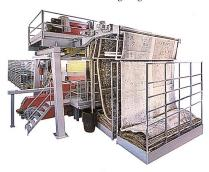
Abb. 7: Die Doppel-Teppichwebmaschine AL-PHA 360
