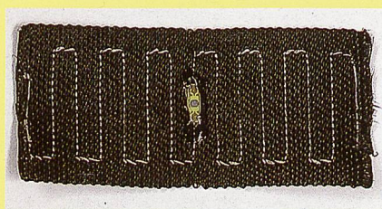
Textiles Transponderetikett von Deister Electronic (Deutschland) mit versilberten Kupferdrähten der Elektrisola Feindraht AG (Escholz matt, Schweiz), Bildnachweis: Elektrisola Feindraht AG
