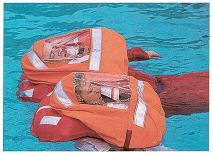
Abb. 2: Das wasserdichte und gasduchlässige GORE® SEA Funktionstextil für Sprayhoods von Rettungswesten schützt Schiffbrüchige vor Gischt und Überflutung. Andererseits ist es gasdurchlässig und erlaubt erstmals, das Atmen in einer vollkommen abgeschlossenen Schutzhaube, bei der auf nachteilige Luftöffnungen verzichtet werden kann.
