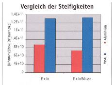
Abb. 3: Steifigkeitsvergleich
