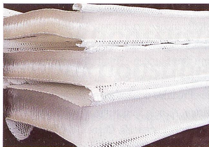
Abb. 2: Die textilen Produkte der HighDistance®. Die Höhe ihrer Abstände ist zwischen 20 und 60 mm stufenlos einstellbar.
