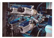
Schussfadenspeicher mit integrierter programmierbarer Schussfadenbremse
