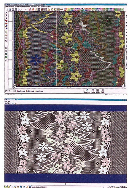
Abb. 1: Technische Ausarbeitung eines Musters auf einer JL 65/1 F, die gemeinsam von den Firmen KARL MAYER und Watkin + West entwickelt wurde. +
