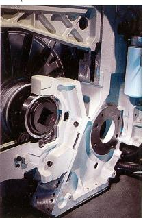
Vibrationsarmer Lauf durch verstärkte Seitenwände
