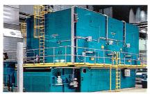
Abb. 2: Hochleistungs-Durchströmtrockner für die Vliesstoff-Industrie (Quelle Internet)
