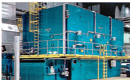
Abb. 2: Hochleistungs-Durchströmtrockner für die Vliesstoff-Industrie (Quelle Internet)
