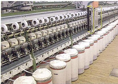
Abb. 5: Die Rotorspinnmaschine BT 904 für elastische Rotona®-Garne
