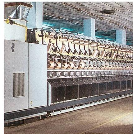
Abb. 4: Die Kabliermaschine CP 10
