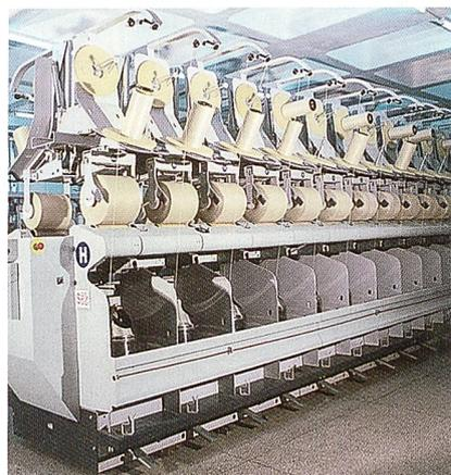
Abb. 1: Die Direktkablriermaschine CD 10
