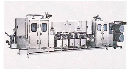
Abb. 10: Kontinüefärbe- und Ausrüstungsmaschine vom Typ BENJAMIN
