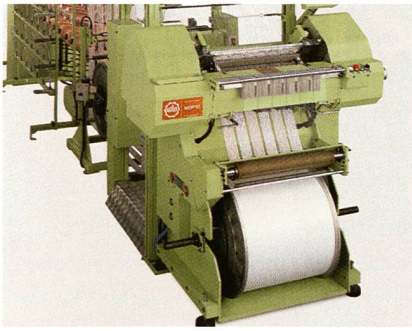
MDR42 – durch die Möglichkeit, maximal 24 Schussstangen bei unbegrenzter Rapportlänge einzusetzen, eröffnen sich ganz neue Mustermöglichkeiten
