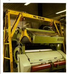
Abb. 14: Modularer Aufbau und Baugruppen der Karde C 60
