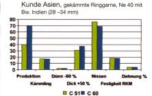
Abb. 11: Vergleich der Technologieresultate für feine gekämmte Ringgarne der C 51 und der C 60
