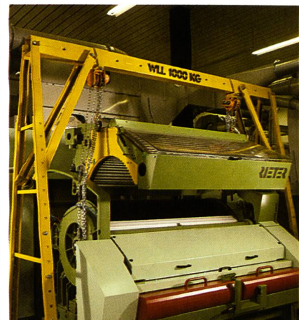
Abb. 14: Modularer Aufbau und Baugruppen der Karde C 60
