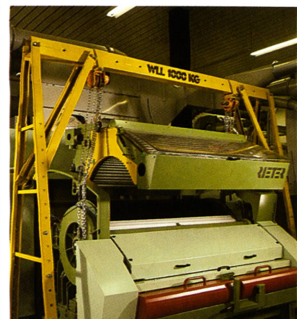
Abb. 14: Modularer Aufbau und Baugruppen der Karde C 60
