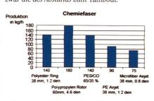
Abb. 12: Produktionshöhen bei Kunden für verschiedene Chemiefasern
