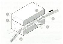
Bild 1: Schnitt durch Garn- und Luftkanal, 1 Garnkanal, 2 Garn unbehandelt, 3 Luftkanal, 4 Garn behandelt, 5 Düsenplatte, 6 Deckplatte
