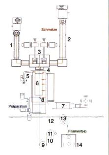
Abb. 1: Prinzipskizze: Komponenten der Schmelzspinnanlage: 1 Mantel-Extruder EX13-25D, 2 Kern-Extruder EX18-25D, 3 Spinnpumpen, 4 Spinnpaket, 5 Monomerenabsaugung, 6 Blasschacht, 7 Luftzufuhr (wassergekühlt), 8 Präparationsstift, 9 1. Galette (beheizt), 10 1. Verstreckungszone, 11 2. Galette (beheizt), 12 2. Verstreckungszone, 13 3. Galette (beheizt), 14 Aufwicklung
