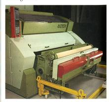
Abb. 1: Die neue Hochleistungskarde C 60
